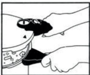
1. Do tlakového hrnca vložte potraviny na varenie. Pootočte gombíkom otvorené/zatvorené v smere hodinových ručičiek (podľa obrázku otvorené).
