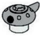
Regulátor tlaku je zařízení, které začne pracovat, když přetlak uvnitř hrnce dosáhne 0,85 kg na cm<sup>2</sup>. Během vaření začne regulátor tlaku hlasitě pískat a tím upozorní, že tlak v hrnci se udržuje na zvolené hodnotě. Je nutné snížit teplotu ohřevu.
