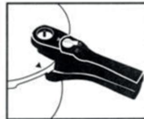
3. Knoflík otevřeno/zavřeno se automaticky otočí proti směru hodinových ručiček (do polohy zavřeno).
