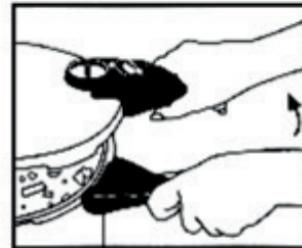
1. Tlakový hrnec je vybaven mechanismem – RYCHLÉ VYPOUŠTĚNÍ – uvolnění páry. Jakmile dovaříte pokrm, otočte hrot regulátoru tlaku do polohy „
