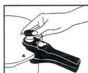
4. Umístěte tlakový regulátor na ventilový otvor tak, aby hrot směřoval na držadlo víka. Jemně zatlačte tak, aby regulátor dosedl na ventilový otvor. Hrot tlakového regulátoru nastavte dle požadovaného tlaku (poloha I nebo II – viz popis regulátor tlaku níže v návodu).
