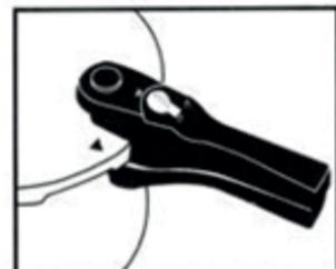
1. Tlakový hrniec je vybavený mechanizmom – RÝCHLE VYPUSTENIE – uvoľnenie pary. Akonáhle dovaríte pokrm, otočte hrot regulátora tlaku do polohy
