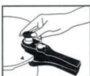
4. Umiestnite tlakový regulátor na ventilový otvor tak, aby hrot smeroval na držadlo pokrievky. Jemne zatlačte tak, aby regulátor dosahol na ventil. otvor. Hrot tlakového regulátora nastavte podľa požadovaného tlaku (poloha I alebo II – vid popis regulátor tlaku nižšie v návode).
